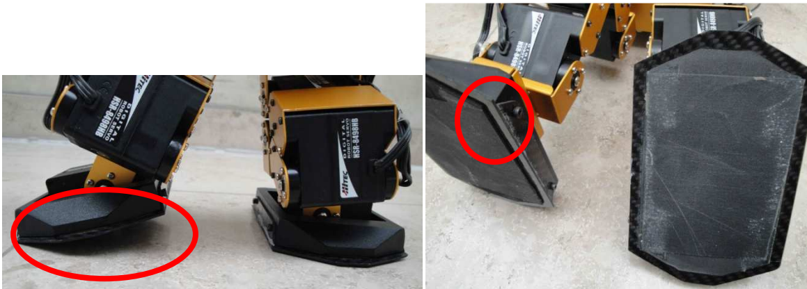
Abbildung 5: Schrägstellung der Füße und Niveauunterschied Moosgummi zu Karbon
