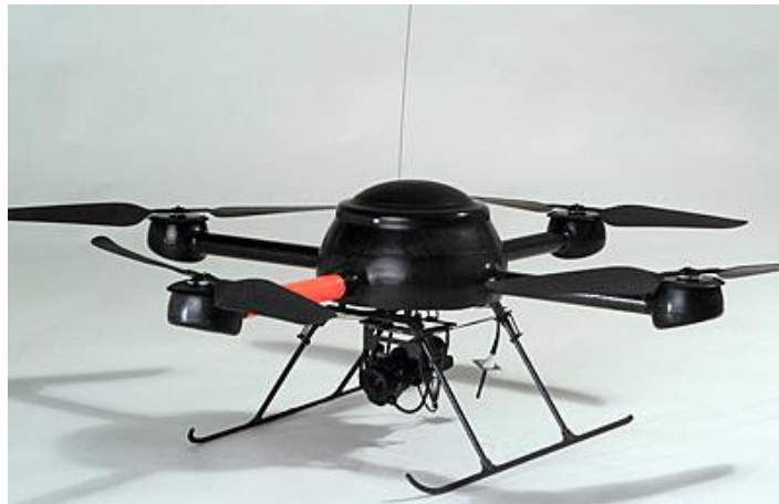
Abbildung 2: Quadrocopter-Modell md4-200 von der Firma Microdrones (Quelle [2])
