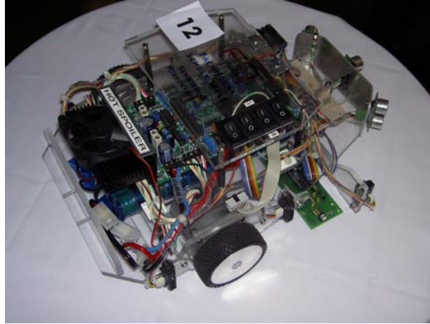
Abbildung 1.2 Roboter „Hotspoiler“ für die RobotChallenge 2006
