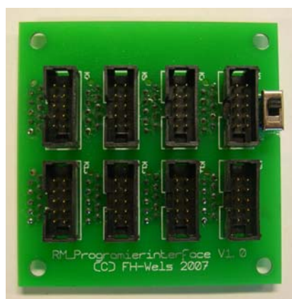
Abbildung 8.1 Bestückte Leiterplatte des Programmier Boards (PC-Interface)
