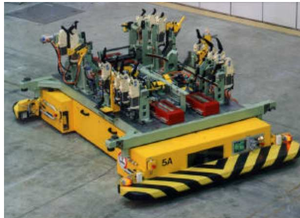
Abbildung 4.3.4: FTS-“Fahrerloses Transportsystem“ (Zopf, 2008, S. 59)
