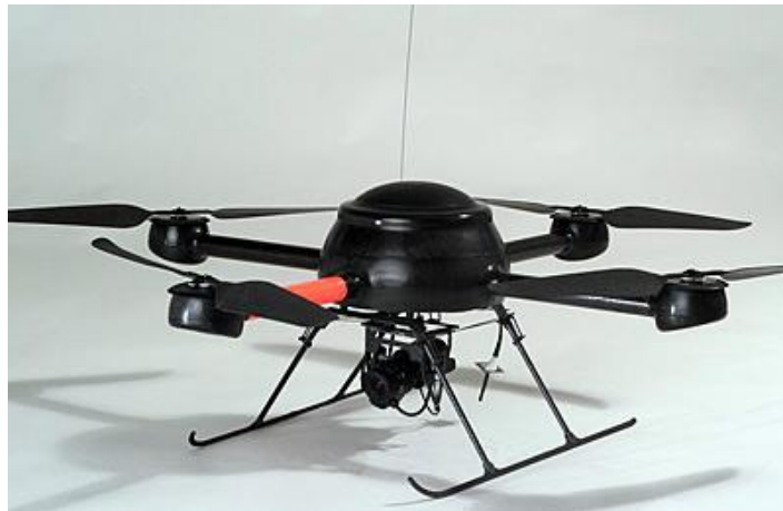
Abbildung 3.1.1: Quadrocopter-Modell md4-200 von der Firma Microdrones (Quelle [2])
