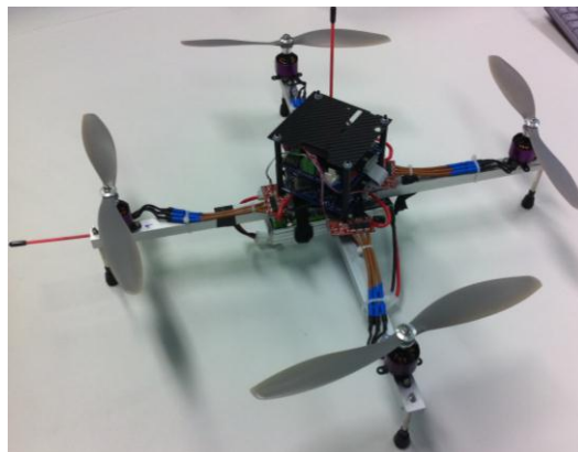
Abbildung 8.4.1: Prototypaufbau des Quadrocopters
