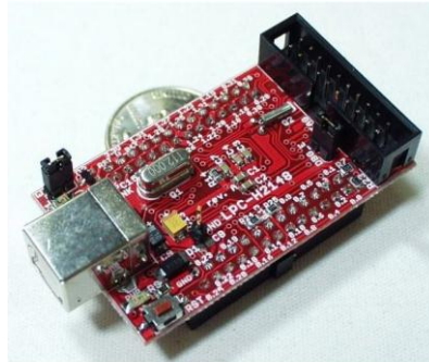
Abbildung 5.3.1: LPC Board 2148 von Sparkfun(Quelle: [15])
