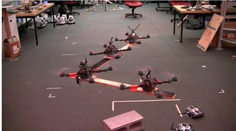
Abbildung 3.6.1: Quadrocopter der Universität Pennsylvania beim Gerüstbau (Quelle: [7])
